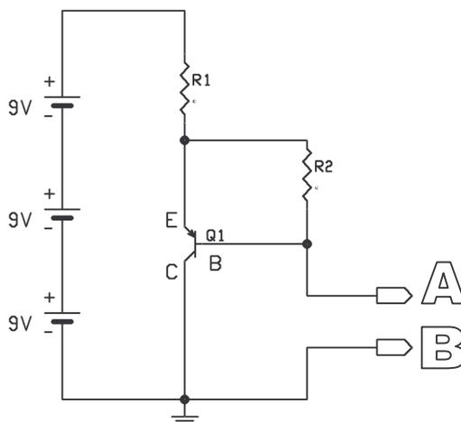
Il transistor Q1 è di tipo PNP e nel mio caso ho usato un BC327, ma modelli simili vanno bene. Non è critico, purchè sia PNP.
