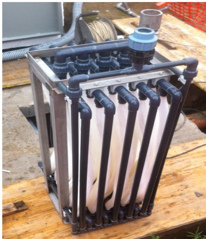
I moduli della serie BRMS sono costituiti da fibre cave supportate su di un robusto telaio in acciaio inossidabile e collegate per mezzo di collettori in PVC. La struttura di sostegno dei moduli serve
