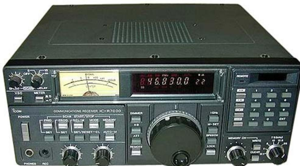
**L'apparato si presenta** come un ricevitore VHF/HF molto flessibile, che si distingue per le sue peculiari caratteristiche. Ad es., eseguendo una ricerca nello spettro dopo aver abilitato la memorizzazione automatica, il  $\mu P$  provvederà a registrare nelle memorie da 80 a 99 le varie frequenze occupate reperite durante la ricerca.
